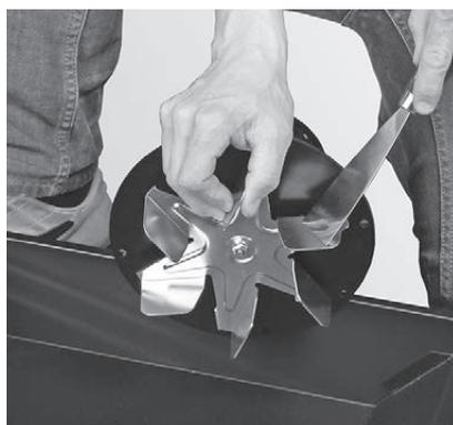
Fig. 73 Nettoyer la roue du ventilateur
