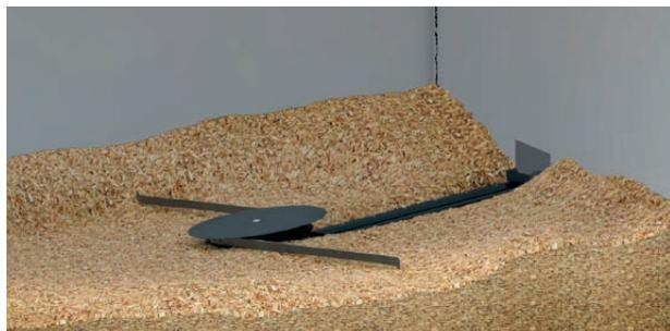
Fig. 4 Silo avec agitateur
