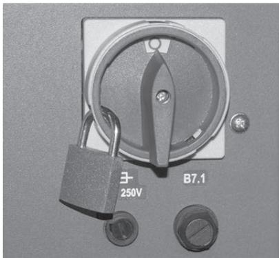
Fig. 63 Mettre l'interrupteur principal en position « O » et le sécuriser contre toute remise en circuit à l'aide d'un cadenas
