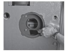
Fig. 37 Nettoyer l'intérieur du caisson de ventilateur
