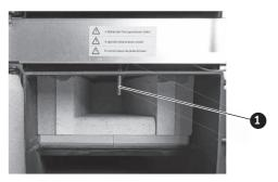
Fig. 40 Nettoyage de la sonde Thermocontrol
