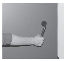
Fig. 29 Activer le levier de nettoyage des surfaces d'échange 5 à 10 fois
