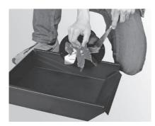
Fig. 36 Nettoyer la roue du ventilateur
