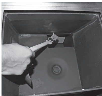
Fig. 67 Nettoyage de la sonde Thermocontrol
