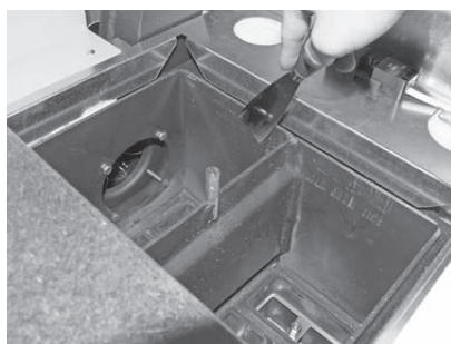
Fig. 88 Nettoyer les surfaces d'échange
