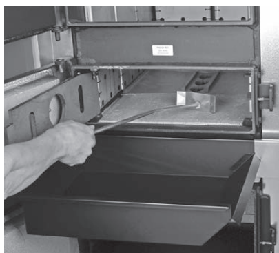
Fig. 20 Accrocher le tiroir à cendres, vider les cendres
