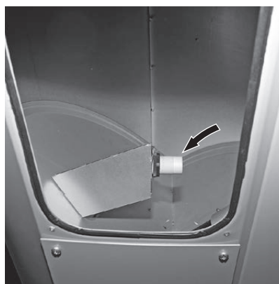
Fig. 95 Commutateur capacitif de l'unité d'alimentation
