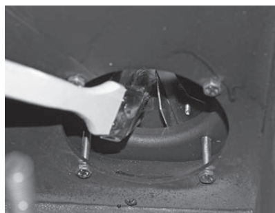
Fig. 87 Nettoyer la roue de ventilation et aspirer
