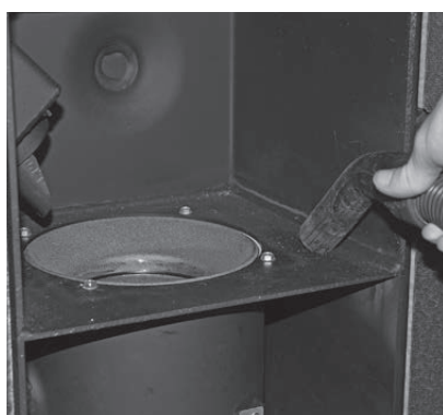
Fig. 69 Éliminer les résidus de combustion de la chambre de combustion
