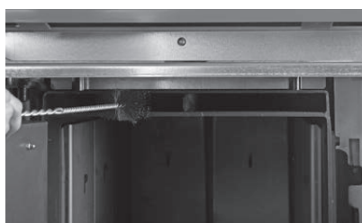
Fig. 40 Nettoyer le système d'aspiration des gaz
