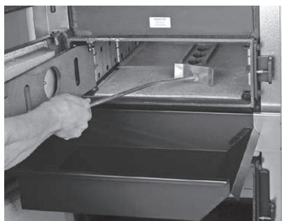
Fig. 38 Accrocher le tiroir à cendres, vider les cendres
