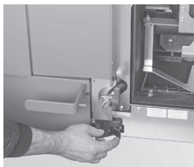
Fig. 62 Ouverture de la fermeture à étrier de tension
