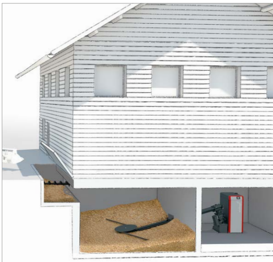
Befüllung des Lagers über Deckenbefüllschnecke, Transport über Schnecke zum Kessel
