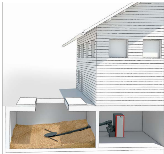
Befüllung des Lagers über Deckenöffnung, Transport über Schnecke zum Kessel
