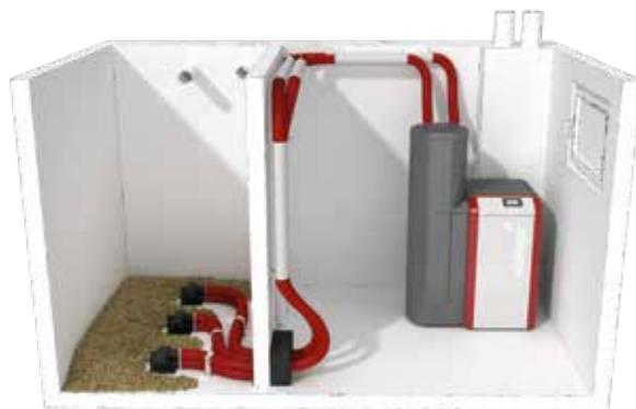
Je nach Form und Größe des Pelletslagers können 1 bis 8 Entnahmesonden platziert werden.
