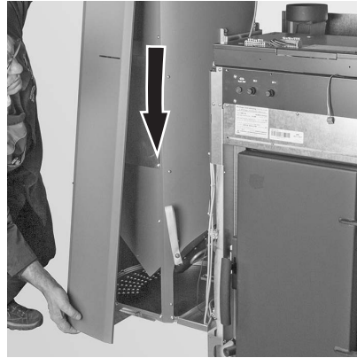
Fig. 82 Blende nach unten schieben und abnehmen (Bajonettverschluss)
