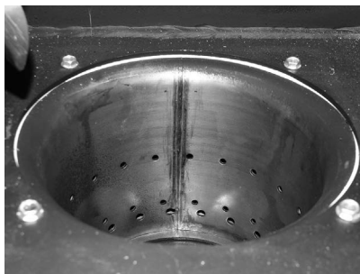
Fig. 58 Sekundärluftlöcher im Brennertopf reinigen
