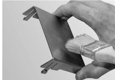
Fig. 69 Umlenblech reinigen (nur bei Pelletskessel mit elektrostatischem Staubabscheider)
