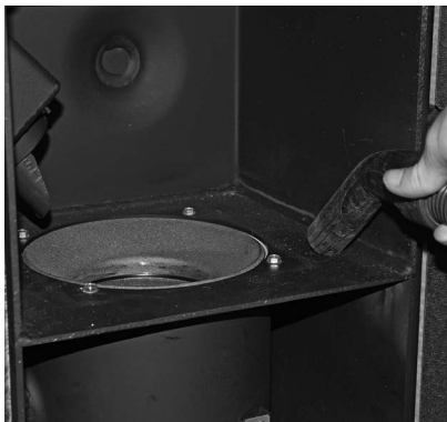
Fig. 50 Verbrennungsrückstände aus dem Brennraum entfernen
