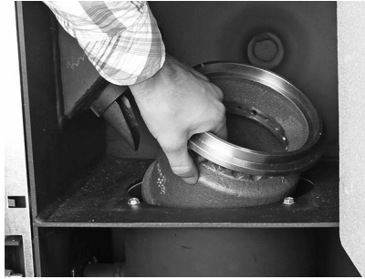
Fig. 52 Konus Unterteil herausheben
