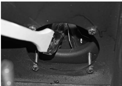
Fig. 70 Gebläserad reinigen und aussaugen
