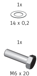
Fig. 92 Sechskantschraube ca. 5 mm einschrauben und Passscheibe auflegen
