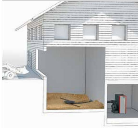
Prelievo orizzontale dal magazzino verso la caldaia
