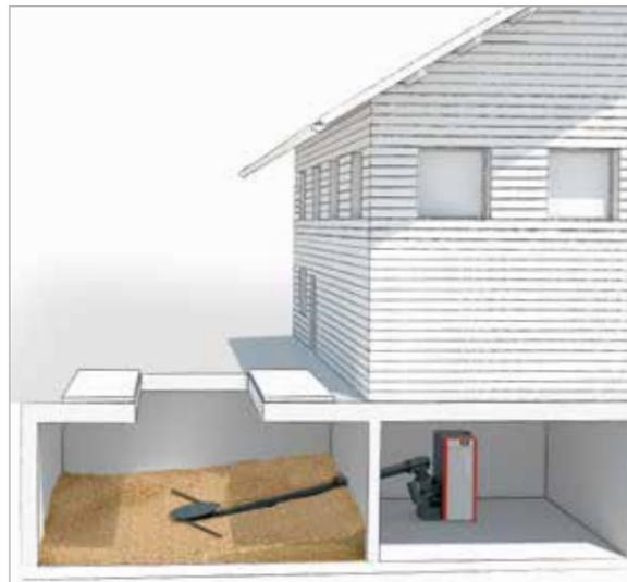
Riempimento del magazzino mediante apertura nel soffitto, trasporto alla caldaia mediante coclea
