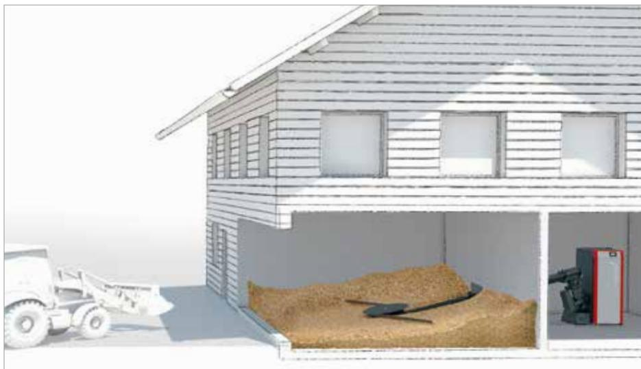
Riempimento diretto del magazzino, trasporto alla caldaia mediante coclea
