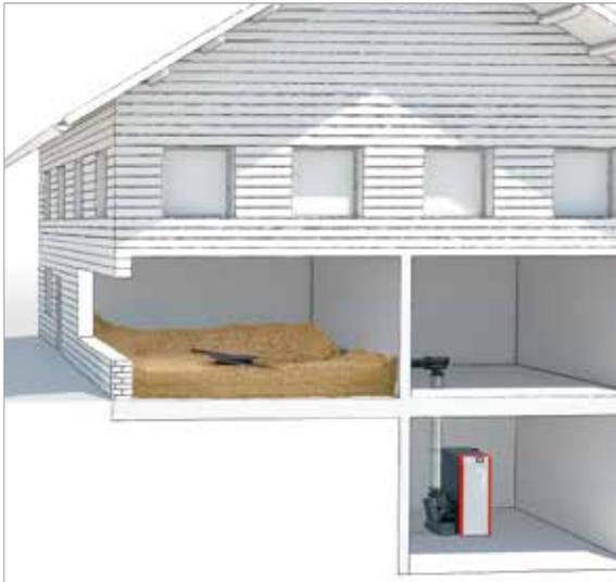
Riempimento diretto del magazzino, collegamento alla caldaia mediante tubo di scarico discendente
