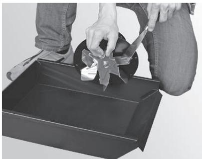
Fig. 36 Nettoyer la roue du ventilateur
