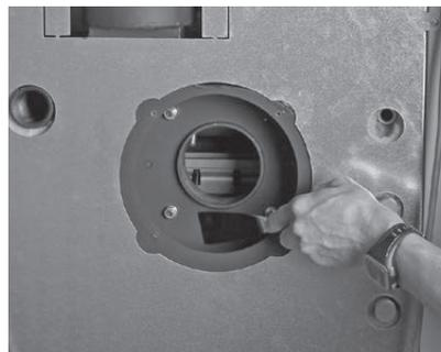
Fig. 37 Nettoyer l'intérieur du caisson de ventilateur
