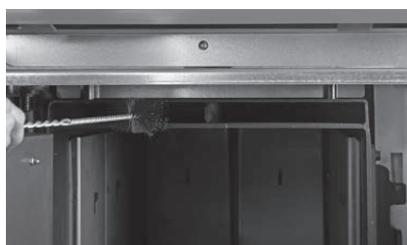
Fig. 56 Nettoyer le système d'aspiration des gaz
