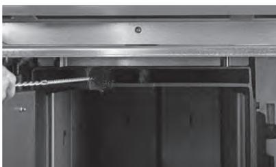
Fig. 32 Schwelgasabsaugung reinigen
