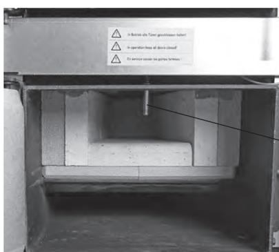
Fig. 39 Thermocontrol-Fühler reinigen
