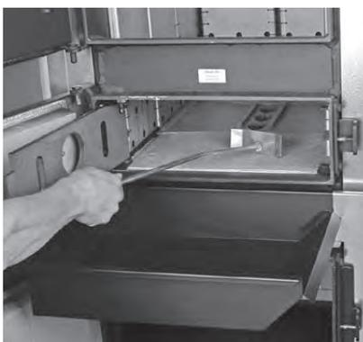
Fig. 7 Aschelade einhängen, Asche entfernen
