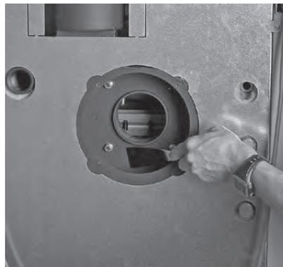
Fig. 36 Gebläsekasten innen reinigen
