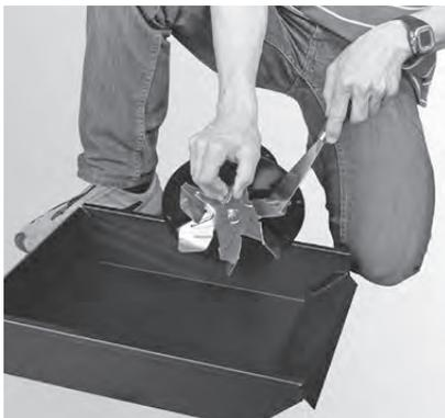
Fig. 35 Gebläserad reinigen
