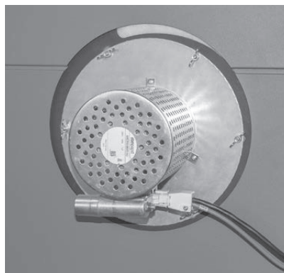
Fig. 72 Gebläse abstecken und abmontieren (Abbildung PuroWIN PW 72–103)
