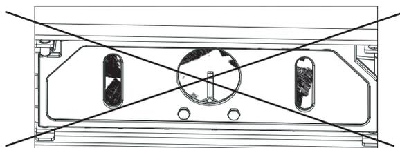
Fig. 11 Bûches mal placées, ne se trouvant PAS devant l'ouverture d'allumage
