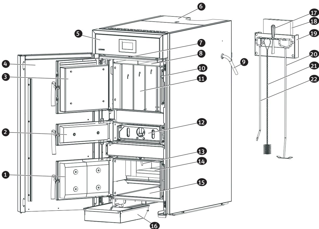
Fig.3 Chaudière bois à gazéification LogWIN 2 EDEL / LogWIN 2 DELUXE
