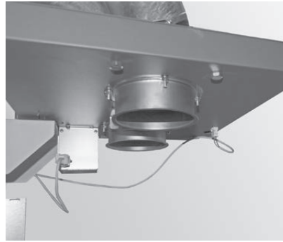
Fig. 207 Beide Stecker anstecken – Ansicht von unten hinten
