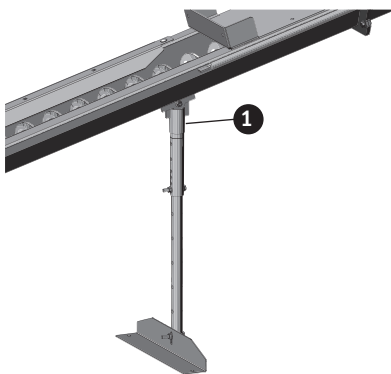
Fig. 165 Stützfuß befestigen und am Boden festschrauben
