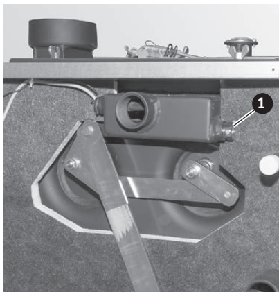
Fig. 20 Montage des Tauchhülse
