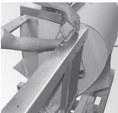
Fig. 176 3 Stk. Stützfüße am Behälter anschrauben
