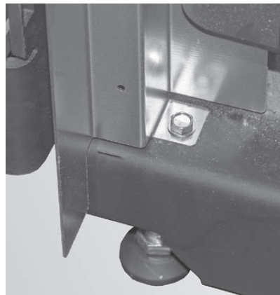
Fig. 33 1 Stk. Schraube vorne bei Sockel
