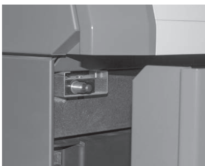
Fig. 84 Türsicherheitsschalter einstellen PuroWIN PW 24-60
