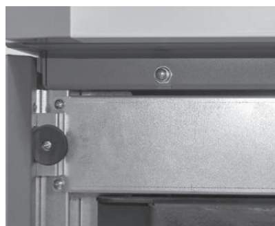
Fig. 85 Türsicherheitsschalter einstellen PuroWIN PW 72-103
