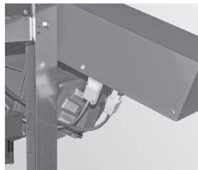
Fig.188 Stecker vom Schaltkasten 2 an Absperrereinheit anstecken
