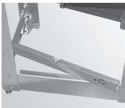
Fig.189 Behälter waagrecht ausrichten
