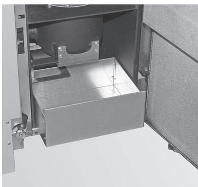
Fig. 38 Retirer le tiroir à cendres et le placer devant la chaudière
