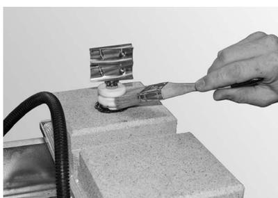
Fig. 71 Nettoyer l'électrode (uniquement pour les chaudières à pellets avec dépoussiéreur électrostatique)
