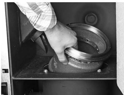
Fig. 52 Retirer le cône de partie inférieure
