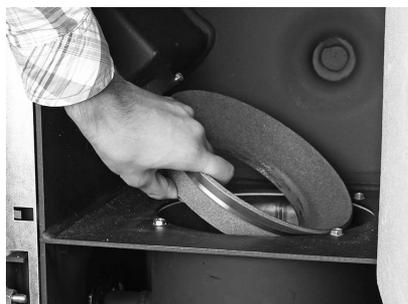
Fig. 51 Retirer le cône de partie supérieure
