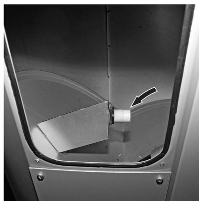
Fig. 85 Commutateur capacitif de l'unité d'alimentation
