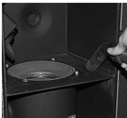
Fig. 50 Éliminer les résidus de combustion de la chambre de combustion
