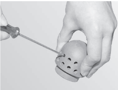
Fig. 97 Nettoyer la broche d'air primaire avec précaution
