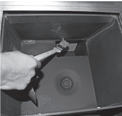
Fig. 88 Nettoyage de la sonde Thermocontrol
