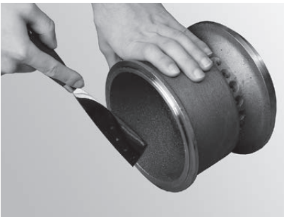
Fig. 94 Nettoyer le cône
