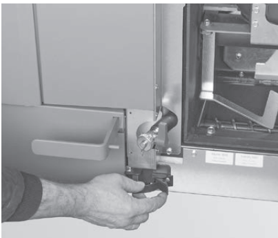
Fig. 83 Ouverture de la fermeture à étrier de tension
