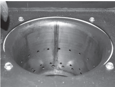
Fig. 98 Nettoyer les volets d'air secondaire dans le creuset du brûleur
