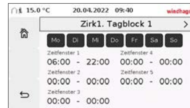
Fig.15 Schaltzeiten und Temperaturen bei „Mit Temperatursteuerung“ (Werkseinstellung Sa, So)
