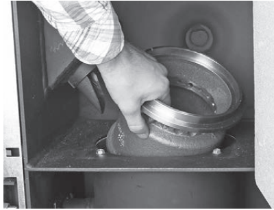
Fig. 92 Konus Unterteil herausheben
