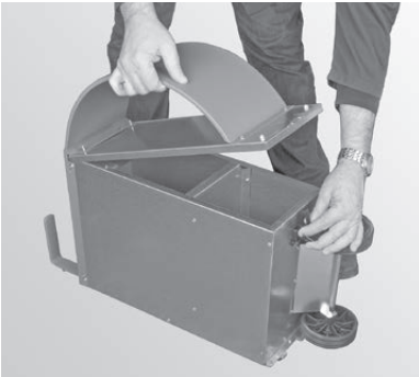
Fig. 86 Spannbügelverschlüsse öffnen, Deckel abnehmen und Aschebox entleeren
