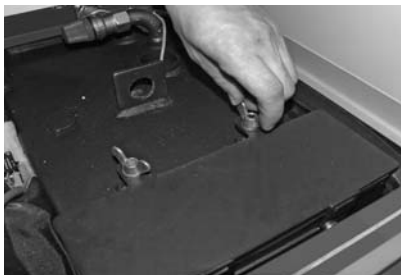
Abb. 143 Flügelmuttern und Deckel entfernen
