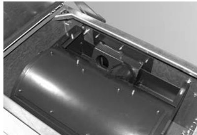
Abb. 138 Grobfilter entfernen, Pellets und Staub entfernen
