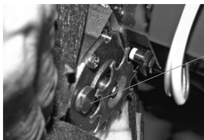
Abb. 153 Zellradschleuse Staub entfernen
