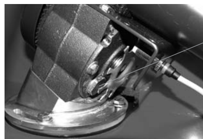
Abb. 155 Zellradschleuse Staub entfernen
