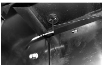
Abb. 128 Thermocontrol-Fühler reinigen (mit Reinigungspinsel)
