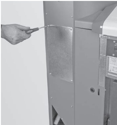
Fig. 82 Schrauben entfernen, Revisionsdeckel abnehmen
