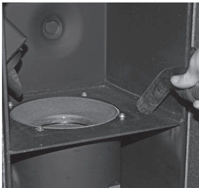
Fig. 53 Verbrennungsrückstände aus dem Brennraum entfernen
