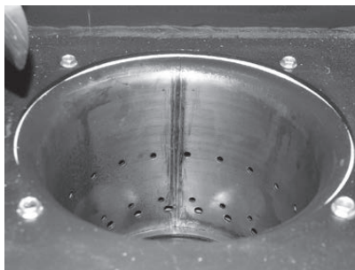
Fig. 61 Sekundärluftlöcher im Brennertopf reinigen
