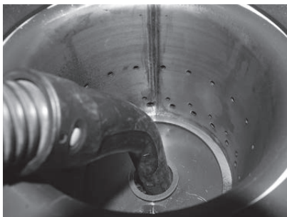
Fig. 62 Primärluftrohr in der Mitte des Brennertopfes aussaugen
